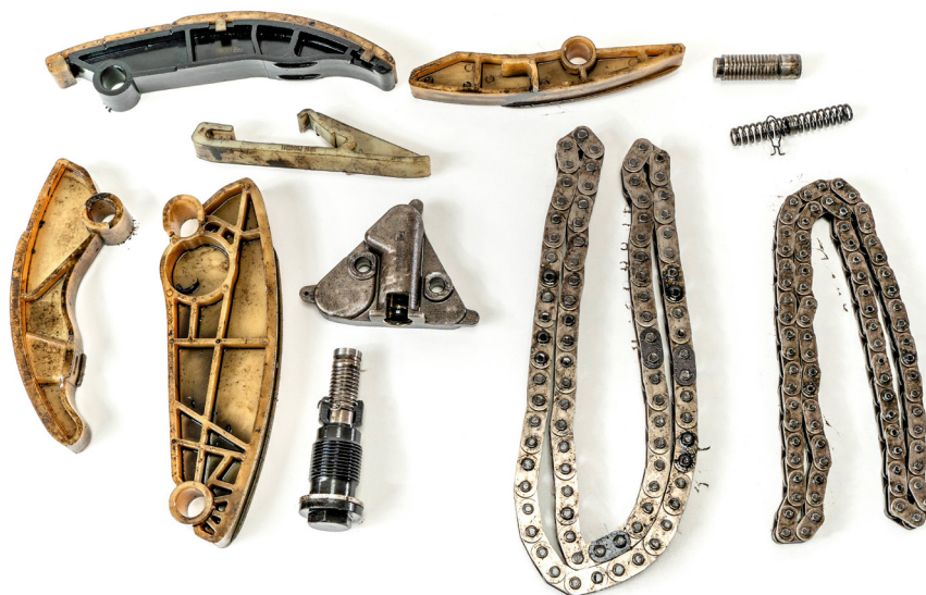
Esempio di materiale difettoso: 381980 adatto a 204DTD - DEFENDER/DISCOVERY 2.0 Example of faulty material: 381980 suitable for 204DTD - DEFENDER/DISCOVERY 2.0
